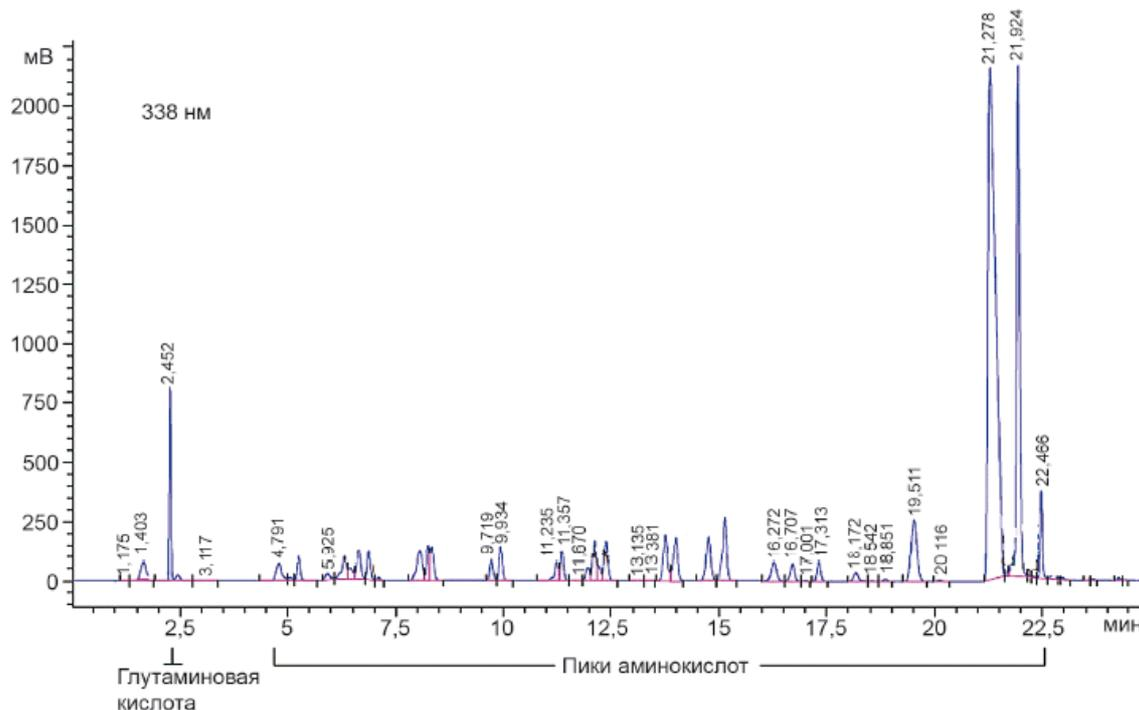
Рисунок Б.1 - Хроматограмма аминокислот с концентрацией 2 мкмоль/см<sup>3</sup>, 2,45 мин - пик L-(+)-глутаминовой кислоты, колонка C18 PA, 3,5 мкм, 4,6 мм×150 мм
